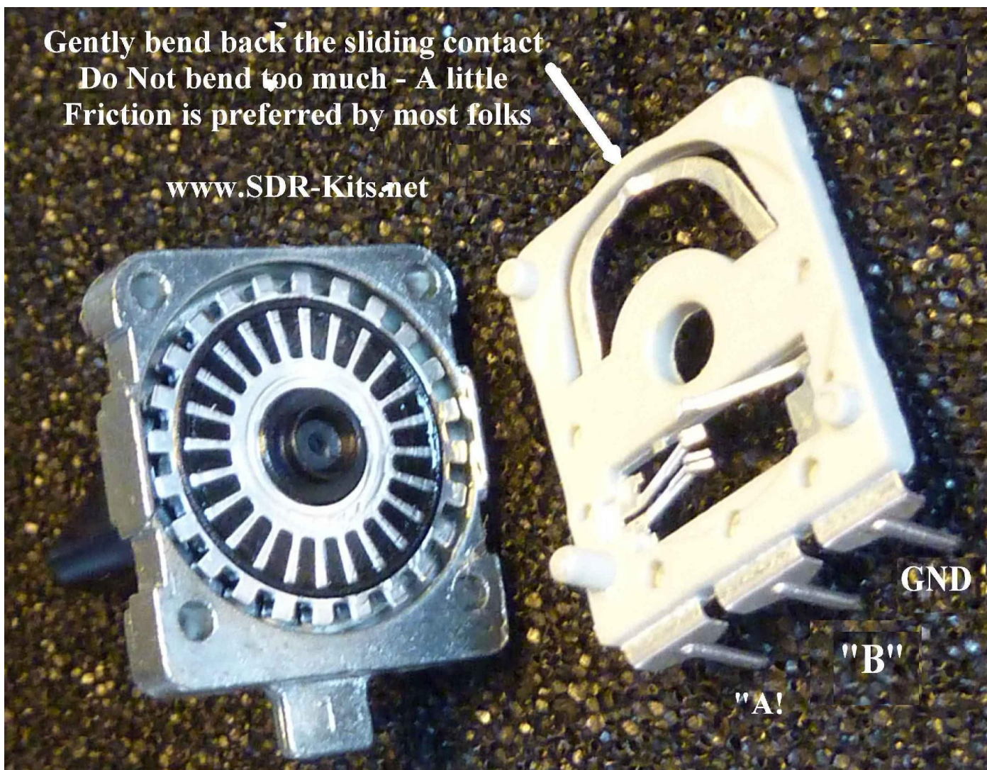
Dodatek 1 - rys 2 – Regulacja sprężyny mechanizmu grzechotki
