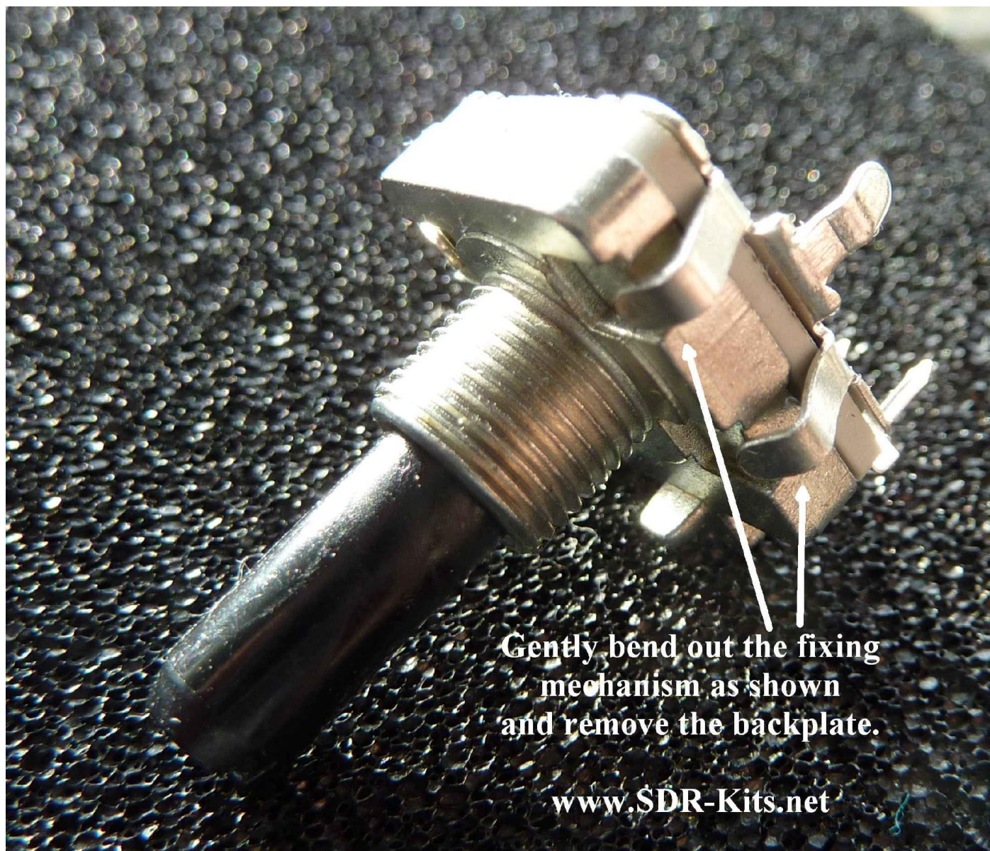
Dodatek 1 - Rys 1 - Regulacja sprężyny mechanizmu grzechotki
