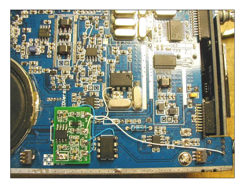
NOTE THAT THE UPPER RIGHT OF THE AGC BOARD LAYS OVER THE 8 PIN DIP IC.
