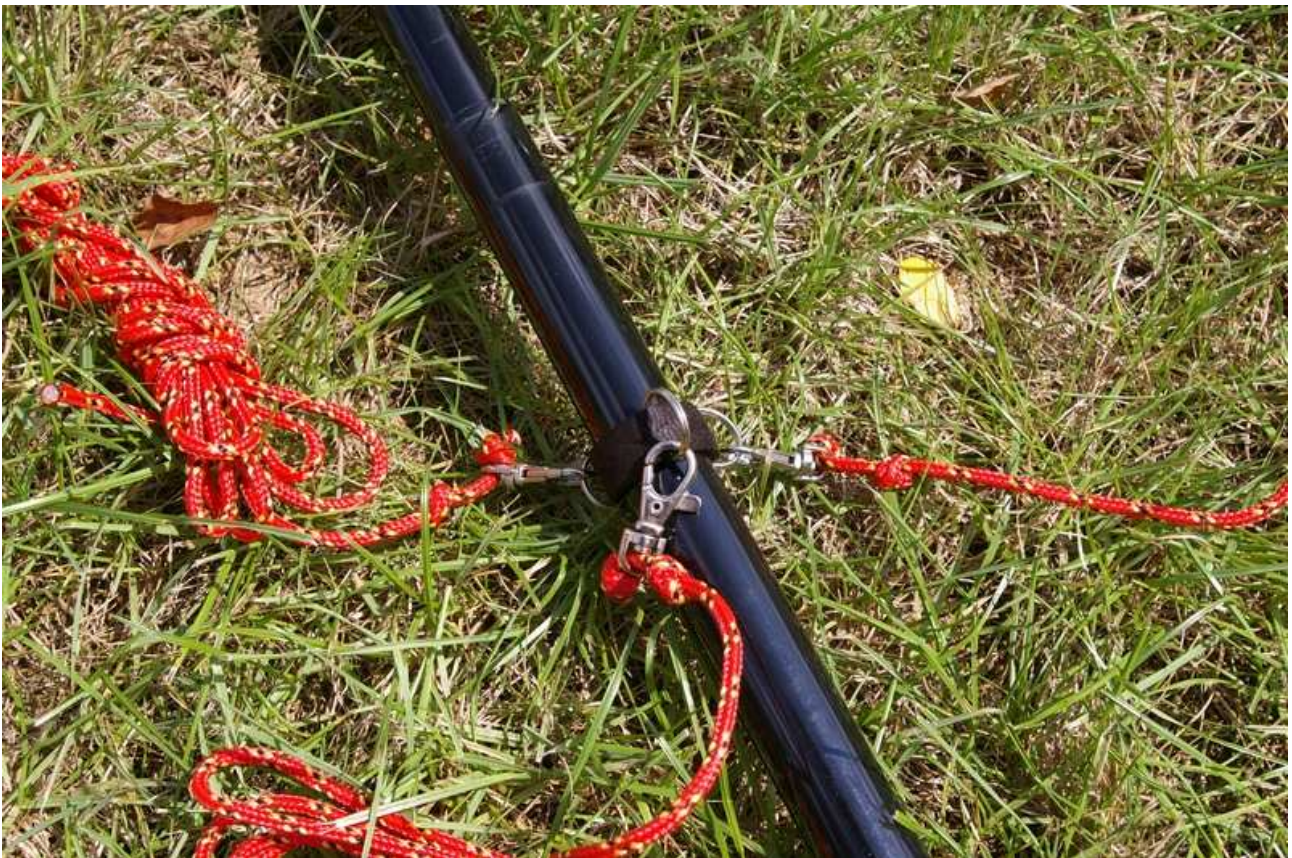
Rys. 5: Opaska do mocowania odciągów – założona na maszt.
