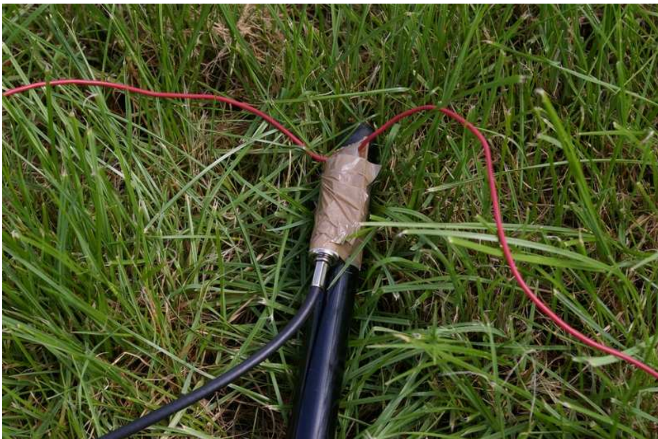
Rys. 16: Mocowanie symetryzatora do masztu.
