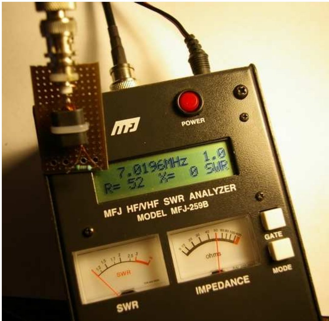
Rys. 11: Testowanie nawiniętego symetryzatora.
