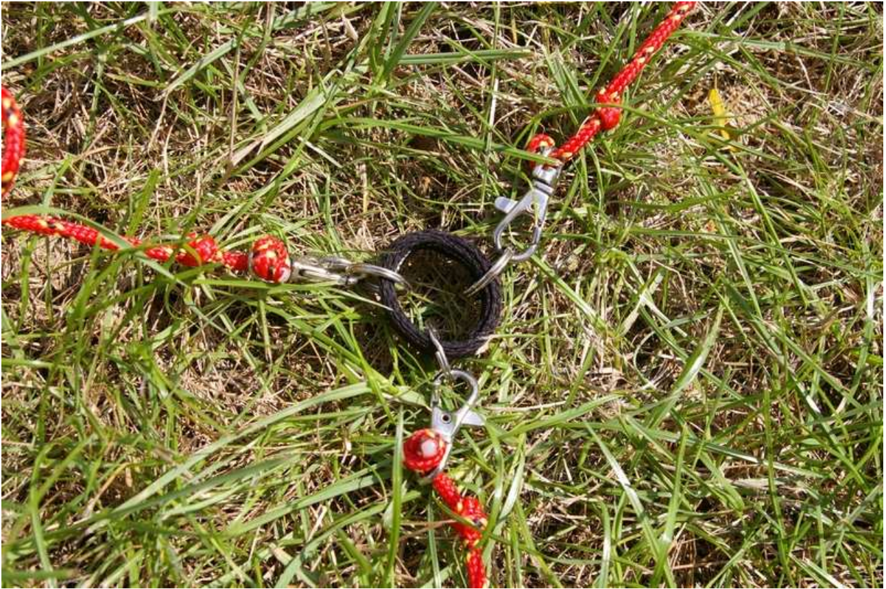
Rys. 4: Opaska do mocowania odciągów masztu.
