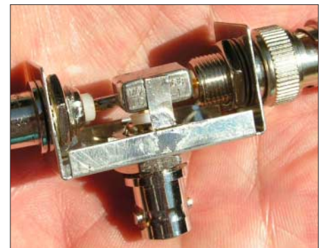
Bild 4: Eine Hand voll Koppler... Der breite Kupferstreifen bildet die Masseverbindung.
