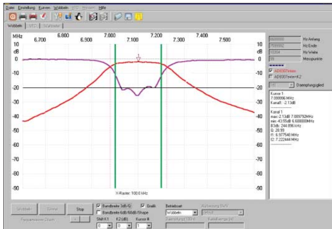
Bild 14: Durchgangsverhalten (rot) und Reflexionsdämpfung (violett) eines LC-Bandpassfilters, die Kurven wurden nachträglich mit dem Kurvenmanager von WinNWT überlagert. Des weiteren sind die Kurven hier verstärkt und zusätzlich eine 20-dB-Hilfslinie eingezeichnet.
