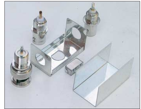
Bild 2: Bauteile für den Messkopf mit TDC-10-1; es findet ein werkseitig modifiziertes Filtergehäuse FG1 Verwendung.
