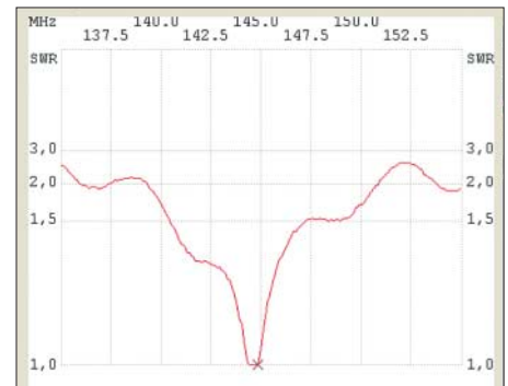
Bild 12: SWV-Verlauf einer 2-m-/70-cm-Duo-bandantenne X30 im 2-m-Bereich nach 15 m Ecoflex 10 (0,7 dB Dämpfung auf 2 m); zusätzlich erkennbar sind Resonanzen der elektrisch fast 9 \lambda langen Speiseleitung.
