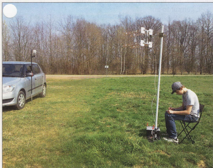
Bild 1: In freier Natur, weitab von störenden Signalen; der Messaufbau für die Helixantenne mit dem Sender am Fahrzeug und dem einige Meter entfernten Empfänger hat sich gut bewährt.
