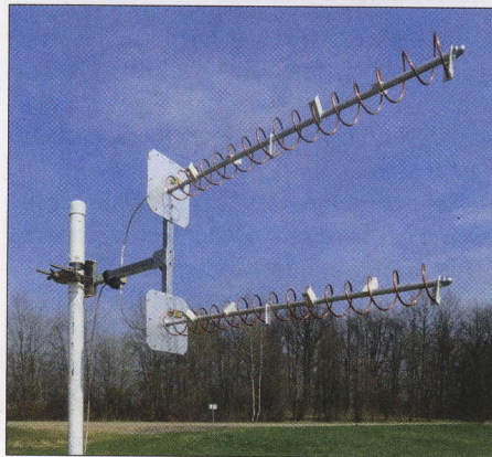
Bild 16: Helixantennengruppe 2 × 50 cm, 15,5 Windungen, vertikal gestockt
