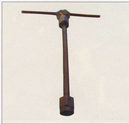
Bild 24: Gestreckter Referenz-Dipol mit den Abmessungen 2 x 32 mm
