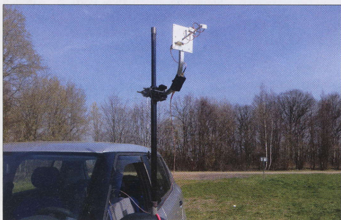
Bild 13: Empfängerseite mit der zu messenden Helixantenne und meinem fleißigen Assistenten
