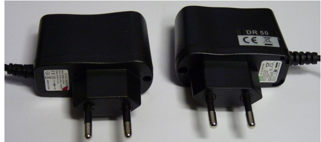
Bild 3.2: Von außen fast wie ein Ei dem anderen – links der Störsender Marel 5V1200, rechts das unauffälligere DTS DYS052-00501100-S3, es wurde zu einem DAB-Tuner geliefert. Das linke Modell war übrigens 10 Gramm leichter als das rechte!
