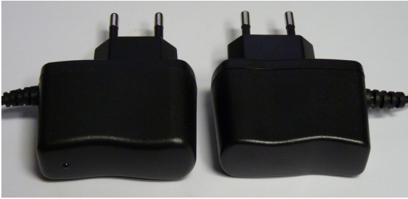
Bild 3.2: Von außen fast wie ein Ei dem anderen – links der Störsender Marel 5V1200, rechts das unauffälligere DTS DYS052-00501100-S3, es wurde zu einem DAB-Tuner geliefert. Das linke Modell war übrigens 10 Gramm leichter als das rechte!
